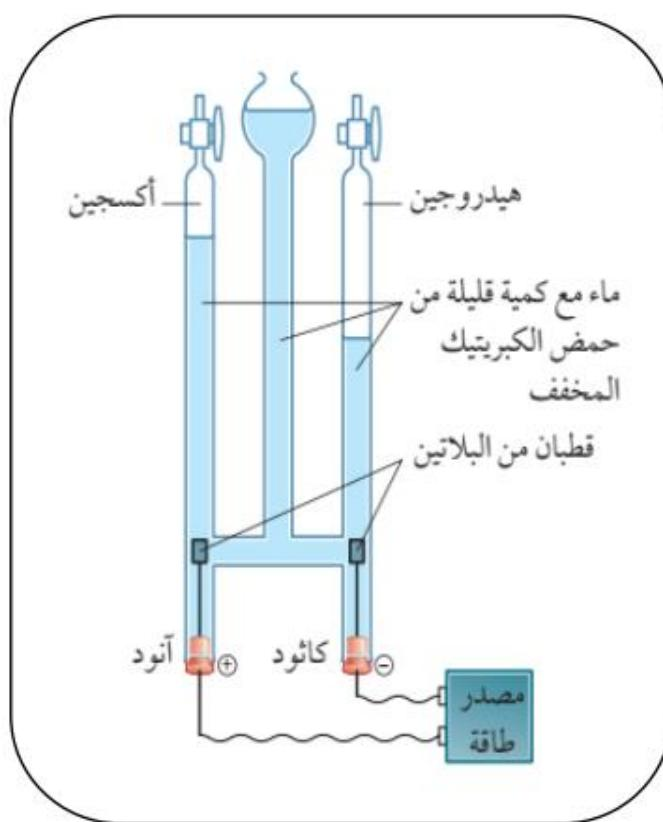
هو خلية إلكتروليتية تستخدم لجمع الغازات الناتجة من عملية التحليل الكهربائي .
